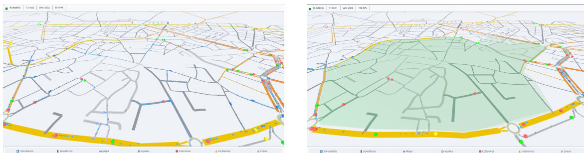
Figura 6.4: Mapa de Talavera con el perímetro real de la ZBE —zonas de Trinidad y Casco Histórico — superpuesto. (Izquierda) sin ZBE: los flujos de coches y camiones atraviesan la zona; (derecha) con ZBE activa: solo las motocicletas la cruzan, mientras coches y camiones la bordean por las arterias perimetrales
