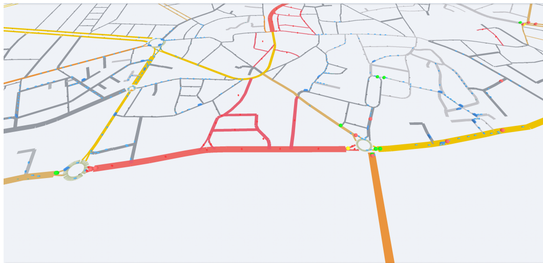
Figura 6.5: HUD durante el episodio: el mapa resalta en rojo las aristas afectadas y se observan las rutas de varios vehículos recalculándose en vivo y saturando las arterias perimetrales
